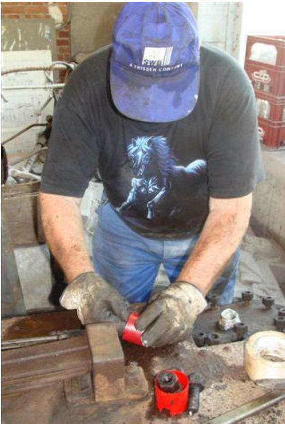
TRAVAUX SUR CHÂSSIS, DÉMONTAGE DES BIELLES ET DÉGRIPPAGE DES PISTONS
