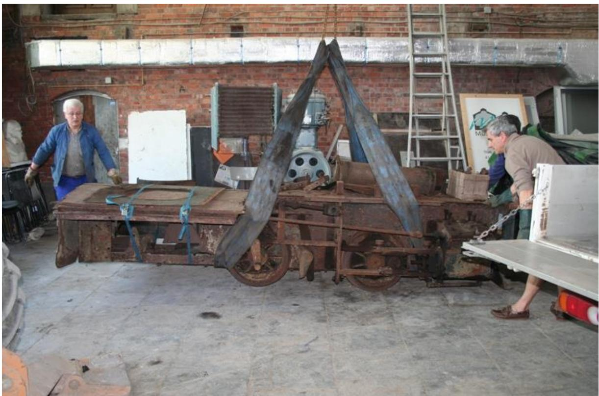
CHAUDIÈRE DÉPOSÉE POUR EXPERTISE ET CONTRÔLE, RELEVÉ DE COTES POUR ÉTUDE ET CALCUL D'UNE NOUVELLE CHAUDIÈRE DANS LES ATELIERS DE L'IPES
