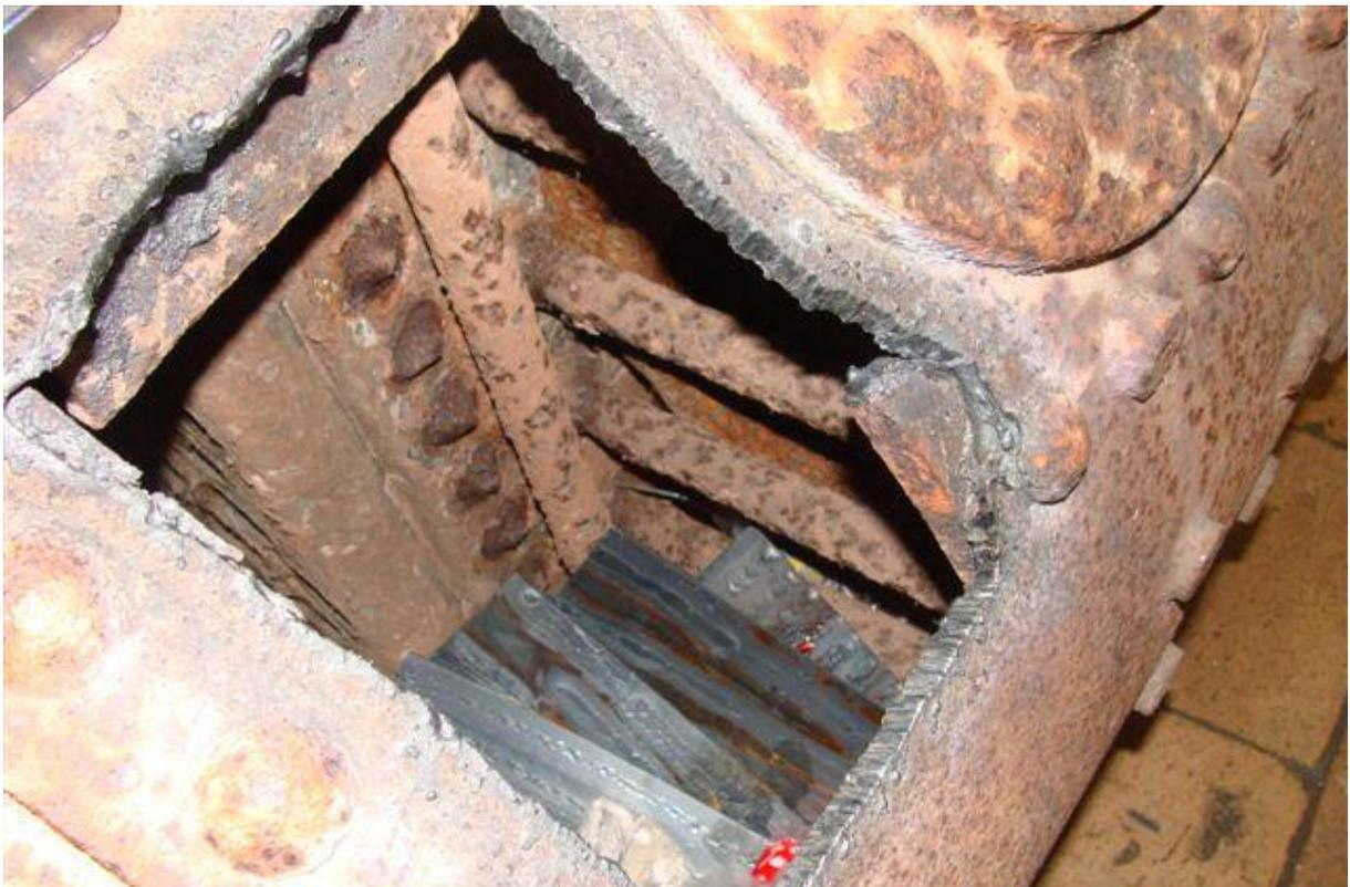
TRAVAUX SUR CHÂSSIS, DÉMONTAGE DES BIELLES ET DÉGRIPPAGE DES PISTONS
